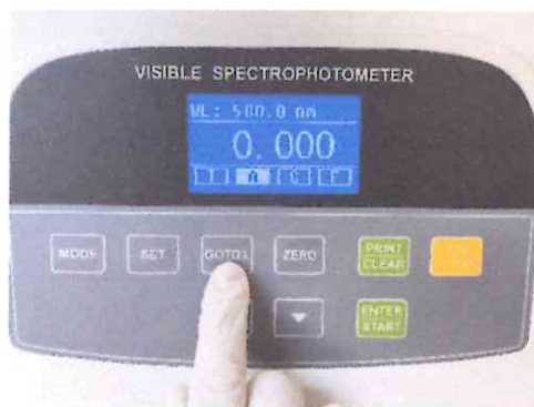
ภาพที่ 36 ปุ่ม GOTOλ เพื่อตั้งค่าความยาวคลื่น ภาพที่ 37 ปุ่มลูกศรเพื่อเพิ่มหรือลดค่าความยาวคลื่น
