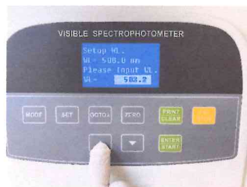
ภาพที่ 36 ปุ่ม GOTOλ เพื่อตั้งค่าความยาวคลื่น ภาพที่ 37 ปุ่มลูกศรเพื่อเพิ่มหรือลดค่าความยาวคลื่น
