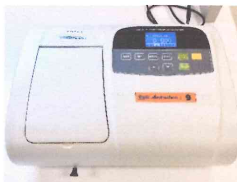
ภาพที่ 31 เครื่องวัดค่าการดูดกลืนแสง ความยาวคลื่น 540 นาโนเมตร
